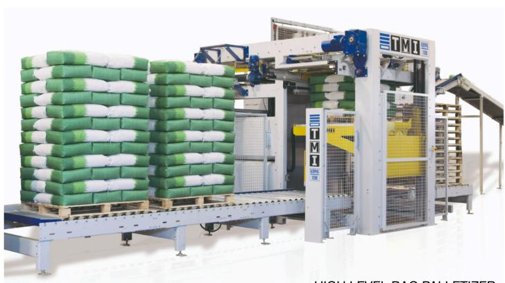
HIGH LEVEL BAG PALLETIZER, LATERAL BAG PUSHING, LAYER COMPACTING, AND MOBILE PLATFORM
